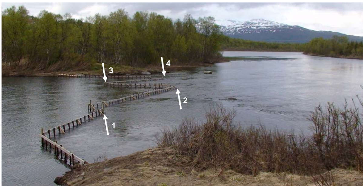
Figur 12 Overvåkingslokaliteten i Laukhellevassdraget (Lakselva), Senja, Troms. Pilene viser åpningene i ledeveggene og plasseringen av videokamera (1-4). Fiskefellene ble satt ut på oversiden av de to åpningene (nr. 3 og 4) som er lengst bort i bildet.
