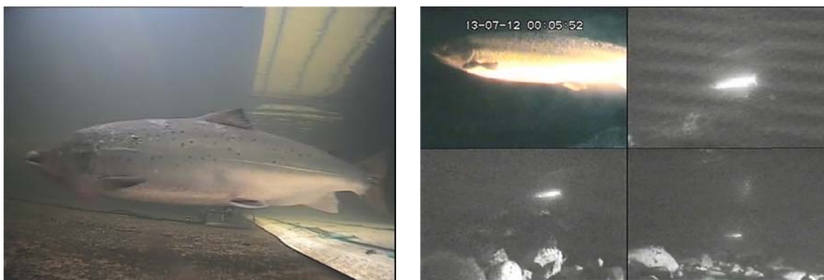
Figur 5 Videoovervåking i åpent tverrsnitt. Bildet til venstre viser en villaks som passerer over damkronen på Bjørsetdammen i Orkla. Legg merke til at neste kamera er synlig bak fisken. Overlapping mellom kameraene sikrer full dekning av tverrsnittet. Bildet til høyre viser et CCTV-bilde med signal fra fire kameraer i Suldalslågen (i nattemørke), og der fisken som observeres i kamera 1 (oppe til venstre) også er synlig på de neste tre kameraene. Fisken er godt synlig på grunn av belysning på bunnen langs overvåkingstverrsnittet.
